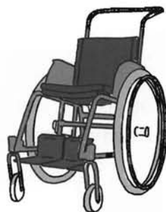
Exempel på manuell rullstol för barn. För att vända behövs minst 1,5 x 1,5 meter.
